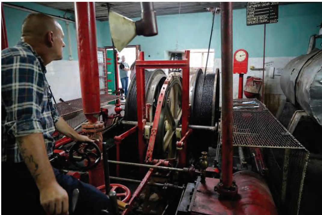
Сењски рудник, њоран и парно постројење извозног окна Senj mine, tower and steam plant of the shaft
