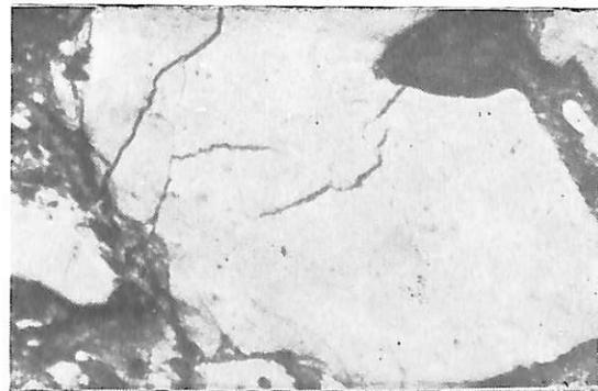
Sl. 6 — Mikroskopski izgled briketa (veće zrno „vitrita” sa sekundarnim prslinama). Odb. svetl. Pov. cca 80 x.
