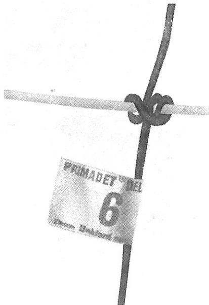
Sl. 5 — Obavezno spajanje detonirajućeg štapina niske energije sa detonirajućim štapinom magistralnog voda pomoću duplog umotavanja.
