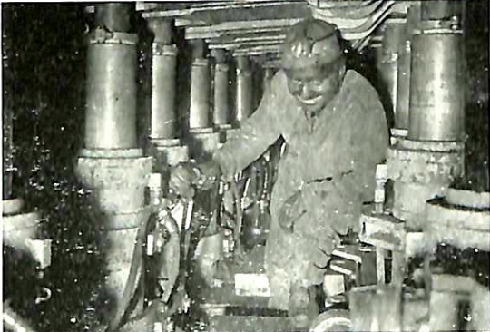
4-Stempel-Wanderfeiler mit Einhebelnachbarsteuerung für Mächtigkeiten von 0,6 m bis 3,5 m mit zuverlässiger Bruchabschirmung
