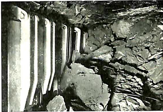
4-Stempel-Wanderfeiler mit Einhebelnachbarsteuerung für Mächtigkeiten von 0,6 m bis 3,5 m mit zuverlässiger Bruchabschirmung
