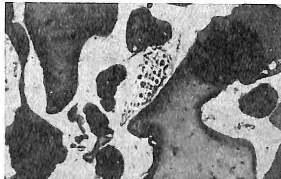
Sl. 11 — Porozan izotropan koks (ugljeni sloj 11)
