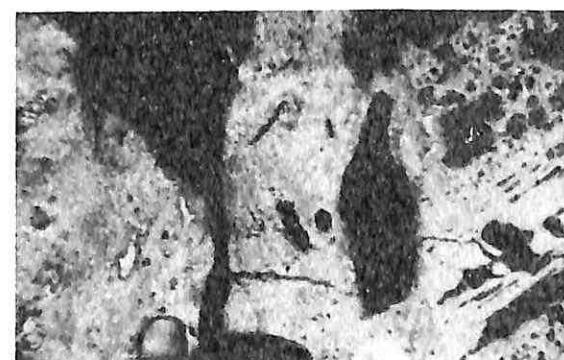
Sl. 6 – Izotropan koks (ugljeni sloj 9) pod većim povećanjem (mozaična struktura koksa i inertne komponente), povećanje 200 x, ulje, odb. svetlost.
