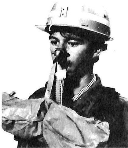
se lako vidi stalno, dok je ventil boce stalno otvoren. Upotrebljivost prestaje kada tekuća potrošnja  $O_2$  premaši dovod kiseonika koji postepeno opada usled pada pritiska u boci. Vreme upotrebe se kreće od 15 minuta (dosta zamorno kretanje) do 30 minuta (čekanje na spasavanje).
