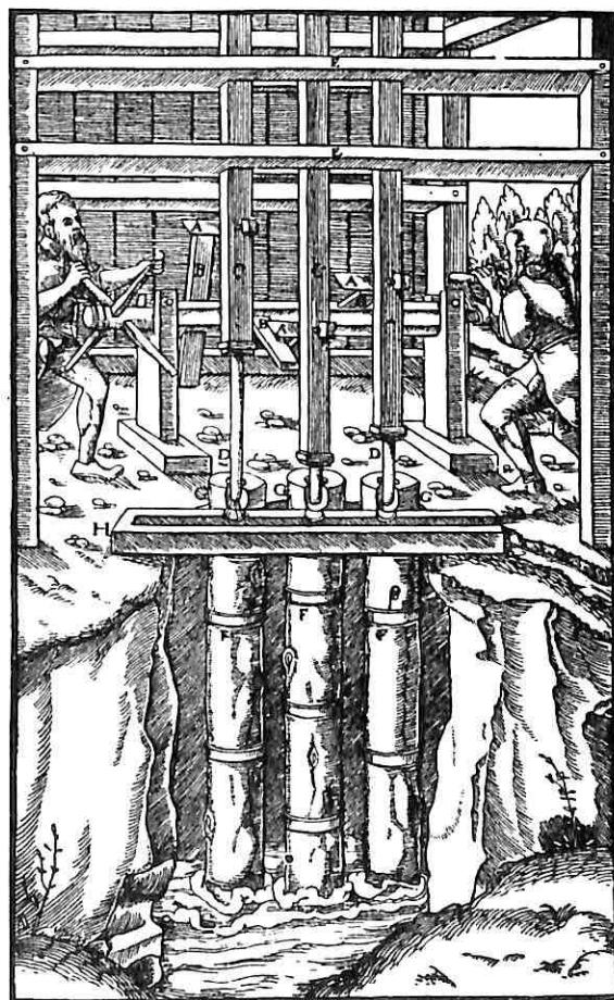
Sl. 18 – Trostruka klipna pumpa. A – dizac klipne poluge; B – hvataci valjkaste osovine; C – gornji, četvrtasti deo klipne poluge; D – njen okrugli deo; E – poprečna greda; F – cev; G – izliv; H – žleb.
