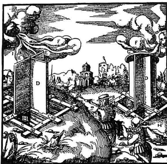
Sl. 24 – Uredaj za hvatanje veta. A – gredice; B – zašiljeni kočići; C – poprečne gredice; D – daske; E – šupljine; F – vetr; G – pokrivač; H – okno; I – uređaj bez pokrivača.
