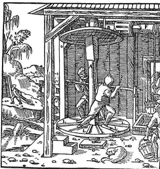
Sl. 11 – Vitao sa gaznim koturom i posrednim prenosom snage
