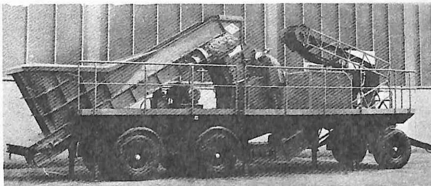
strisan je pokretan vučni uređaj koji se sastoji od ulaznog bunkera kapaciteta 1,5 m<sup>3</sup>, lančanog transportera širine 700 mm, udarne drobilice 080/075, vibro sipke, odvozne trake i troosovinske šasije. Zavisno od ulaza i kranje granulacije postižu se kapaciteti i od 100 t na čas.
