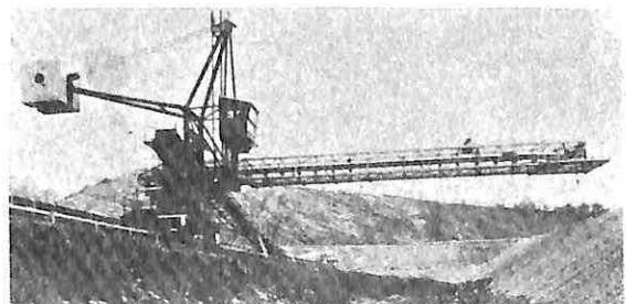
postoji u nepokretnim i pokretnim modelima. Standardni nepokretni odlagači se koriste za kružno nanošenje i nalaze se na nosećem tornju, čija visina može da omogući odlaganje do 115.000 m<sup>3</sup> jednom mašinom. Standardni pokretni odlagači stvaraju dugačke gomile paralelno ili u nizu. Standardne širine traka od 650, 800, 1000 i 1200 mm omogućuju da pretovarači prilagode protok čak i do 1000 t na čas. Za velike kapacitete od 12.000 t/čas proizvođači izrađuju vanserijske trake široke 1400 do
