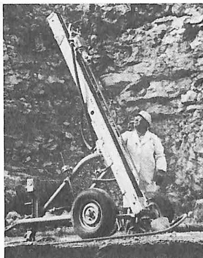
do 4 m i postavljena je na cevastoj šasiji na dva točka. Zavisno od terena, može da buši vertikalne, kose i horizontalne bušotine prečnika do 80 mm i dužine do 15 m. Ukupna težina bušilice je samo 180 kg, što je čini veoma pokretljivom za različite primene.
