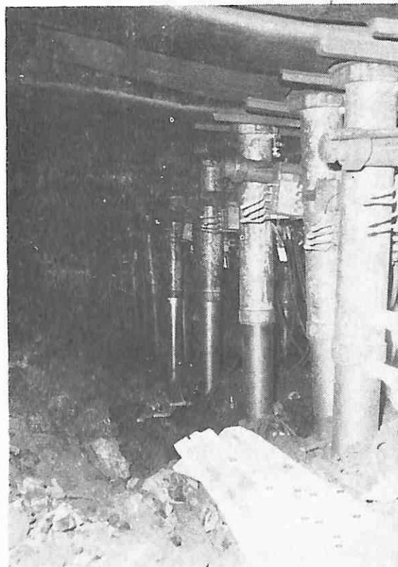
Sl. 4 — Primena samohodne hidrauličke podgrade firme Hemscheidt kod velenjske otkopne metode.
