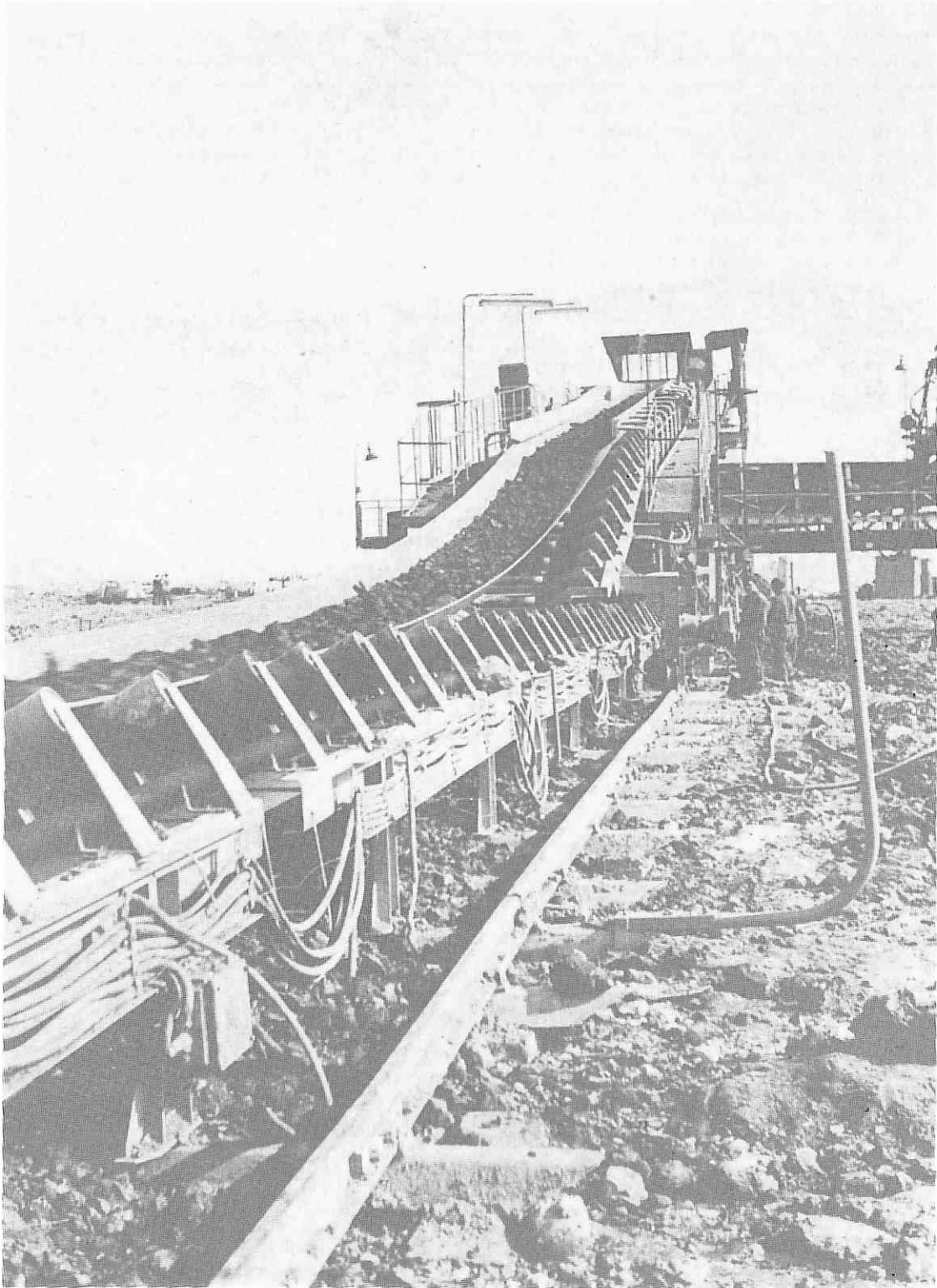
Sl. 7 — Pretovarna stanica na tračnom transporteru za odvoz jalovine.
