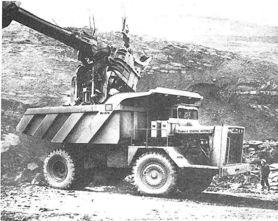
Sl. 14 — Auto-kiper nosivosti 59 Mp na utovaru pod bagerom
