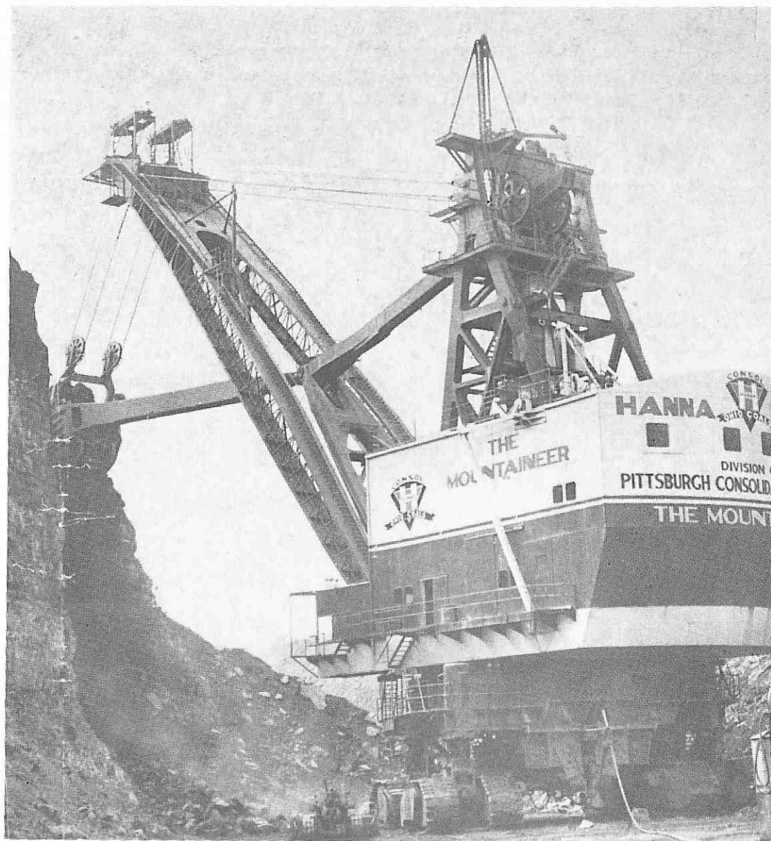
Sl. 1 — Bager kašikar za direktno prebacivanje sa zapreminom kašike q_k = 50 \text{ m}^3 , časovnim kapacitetom Q_h = 3876 \text{ m}^3/\text{h} , radnim ciklusom t_c = 45 \text{ sec.} , visinom pražnjenja H_p = 30 \text{ m.} i radijusom dejstva R_d = 88 \text{ m} pri pomenutoj visini pražnjenja.
