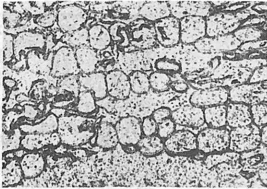
Sl. 10 — Jaka pirijska mineralizacija telinita. Odb. svetlost, pov. 160 x, vazduh. Rovni ugalj.
