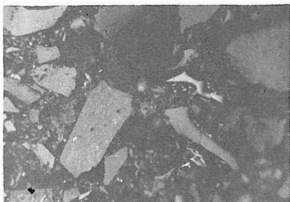
Sl. 16 — Cist ugalj (vitrit+klarit) u klasi -0.75+0.00 mm. Odb. svetlost, pov. 430 x, ulje. Koncentrat uglja
