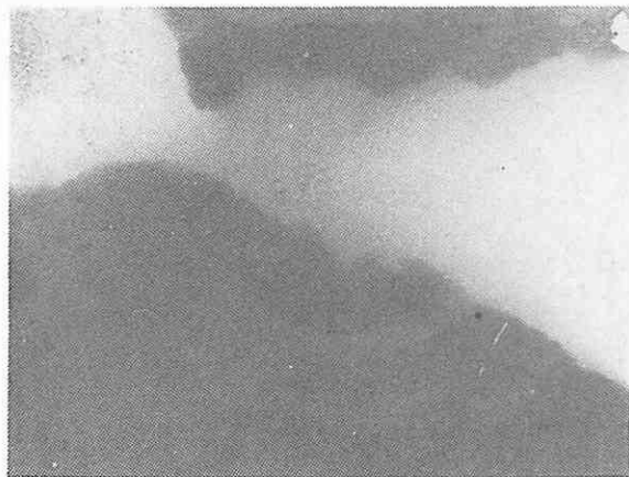
Sl. 16 Prostor između dva zrna galenita ispunjen adsorbovanim tečnim ditiofosfatom A-31. Direktno povećanje 80.000 x, ukupno 120.000 x.
