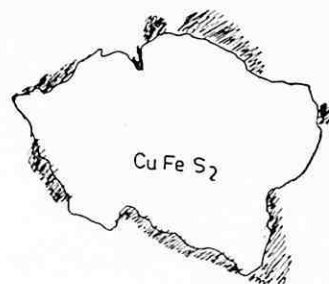
Sl. 34 — Halkopirit iz rastvora K-amil ksantata, koncentracija 30 mg/l. Direktno povećanje 51.400 x, ukupno povećanje 77.000 x.
