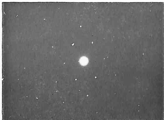
Sl. 27 — Difrakcioni snimak doöijen sa površine kovelina iz suspenzije u vodi.
