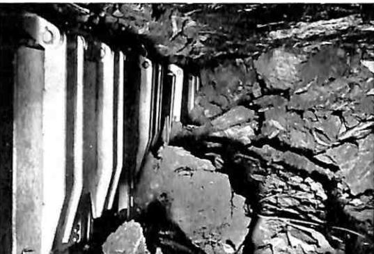
4-Stempel-Wanderpfeiler mit Einhebelnachbarsteuerung für Mächtigkeiten von 0,6 m bis 3,5 m mit zuverlässiger Bruchabschirmung
