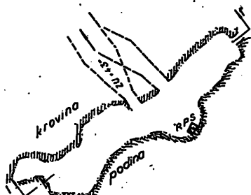
Sl. 1 — Zasipni uskopi na trećoj etaži jednog otkopa Рис. 1 — Восстановление для добычи заключочной породы на третьем горизонте одного забоя.
