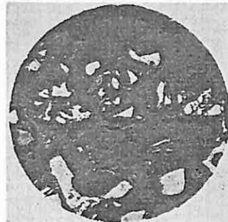
Sl. 15 — Mikrosnimak briketa opita br. 10, tablica 17 i 19. Reflektovano svetlo; uveličanje 40 puta. Deo briketa koji nije dobro homogeniziran. Koncentracija sitnih zrna sa mnogo mase
