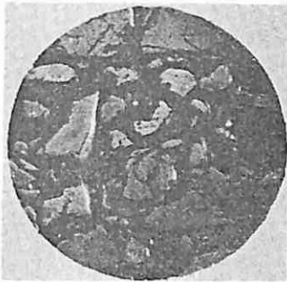
Sl. 16 — Mikrosnimak briketa opita br. 10, tablica 17 i 19. Reflektovano svetlo; uveličanje 40 puta. Dobro granulirana smeša hrompikotita i koka sa šupljina u vezivu Abb. 16 — Brikett-Mikroaufnahme, Versuchsreihe Nr. 10, Tab. 17 und 19. Refl. Licht, Vergr. 40-fach. Gut granuliertes Gemenge von Chrompikotit und Koks mit Bindemittel Hohlräumen
