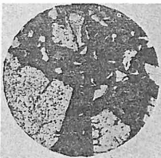
Sl. 13 — Mikrosnimak briketa opita br. 4, tablica 16. Reflektovano svetlo; uveličanje 40 puta. Dobro granuliran i dobro vezan deo briketa bazalnim vezivom Abb. 13 — Brikett-Mikroaufnahme, Versuchsreihe Nr. 4, Tab. 16. Refl. Licht, Vergr. 40-fach. Gut granulierter und gut ver kitteter Brikettteil mit Grundbindemittel
