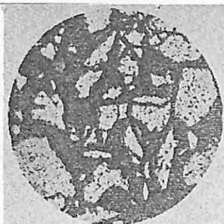
Sl. 12 — Mikrosnimak briketa opita br. 4, tablica 16. Reflektovano svetlo; uveličanje 40 puta. Dobro granuliran i dobro vezan deo briketa — pornim vezivom Abb. 12 — Brikett-Mikroaufnahme, Versuchsreihe Nr. 4, Tab. 16. Refl. Licht, Vergr. 40-fach. Gut granulierter und gut ver kitteter Brikettteil — mit Porenbindemittel
