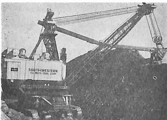
Sl. 11 — Bager kašikar Model 6360 proizvodnje firme „Marion“ — SAD. Dužina strele mu je  $70,5 \text{ m}$ ; zapremina kašike  $138 \text{ m}^3$ ; kapacitet  $41 \text{ milion m}^3/\text{god.}$
