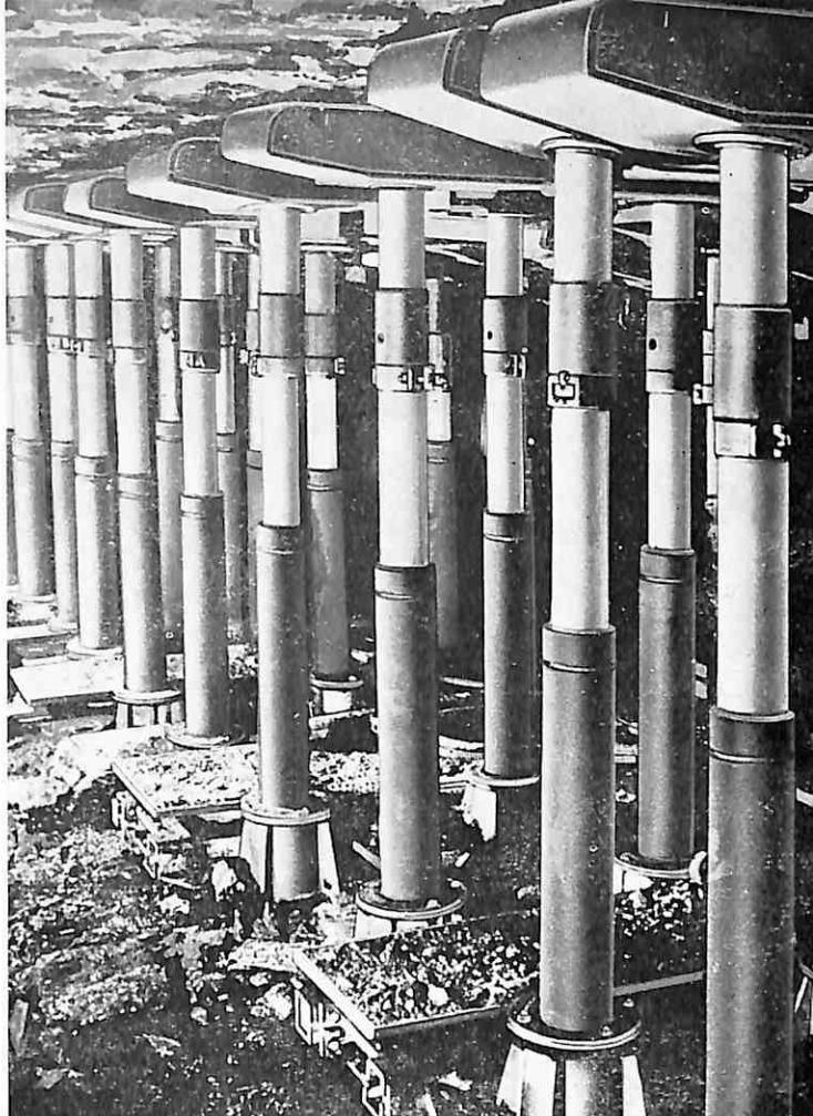
Hidraulična samohodna podgrada tip MOP-BZ2 sa uspehom se primenjuje u poljskim rudnicima ugaļja.
