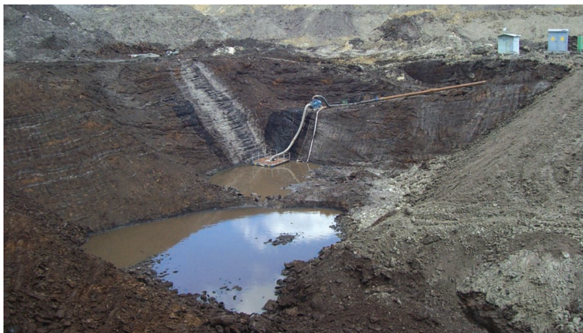
Слика 1, Јаловинске масе унутрашњег одлагалишта Поље-Б затрпавају водосабирник и неоткопани угљ, извор: документација ЕПС-а, 2006.
