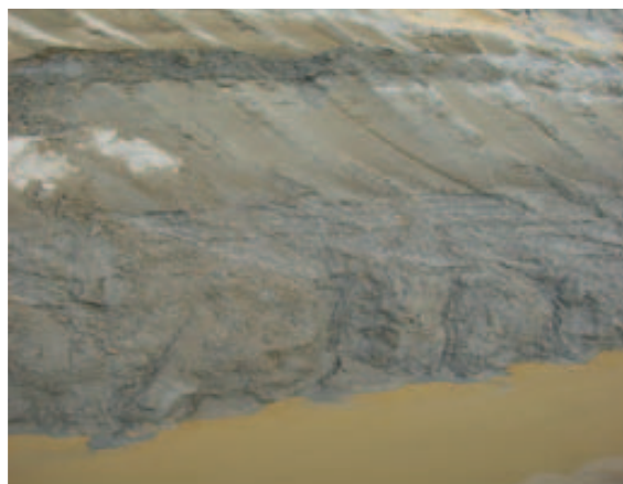
Слика 2, Површински коп Дрмно, висок ниво подземних вода у јаловинској етажи
