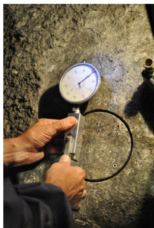
Слика 13, Мерење деформација еластичним растерећењем на мерној локацији/месту
