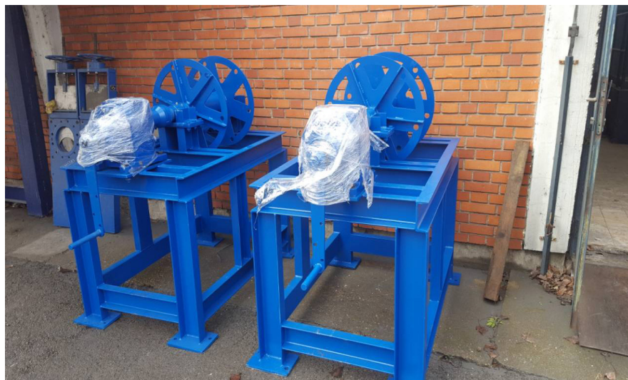
Слика / Figure 3, Приказ конструисаног витла / View of the constructed winch
