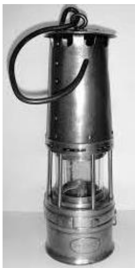
U godini podizanja Drugog srpskog ustanka konstruisana je Dejvijeva lampa (Humphry Davy), čijom je upotrebom znatno smanjen broj nesreća u rudnicima.
