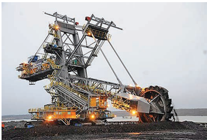
Роторни багер SchRs 740×25/6 у раду на површинском копу Тамнава Западно поље, 26.12.2014. (Фото: kWh Електричарства Србије) Rotary excavator SchRs 740×25/6 in operation at the open pit Tamnava Zapadno polje, 26.12.2014. (Photo: kWh Electric Industry of Serbia)
