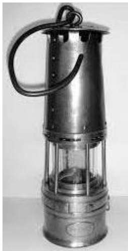
У години подизања Другог српског устанка конструисана је Дејвијева лампа (Humphry Davy), чијом је употребом знатно смањен број несрећа у рудницима.
